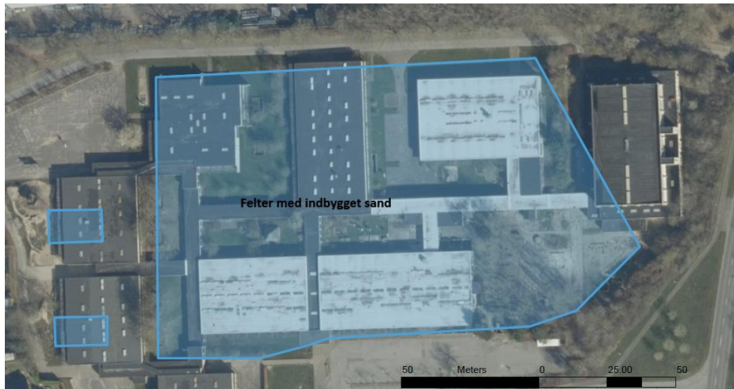
Figur 3: Område hvor jorden er udskiftet med komprimeret sandfyld
